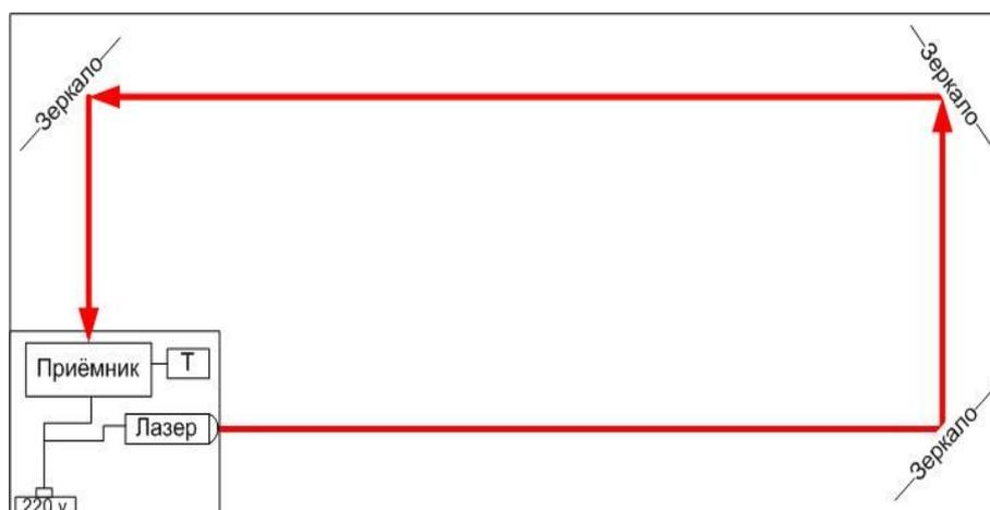
Рис. Ход лазерного луча в системе зеркал.
